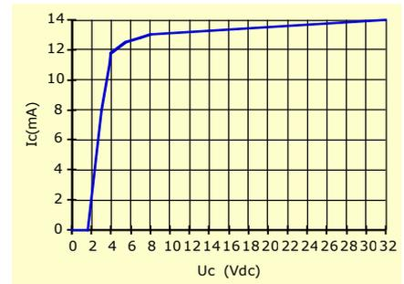
**Caractéristiques de sortie / Output characteristics (at 25°C)**
