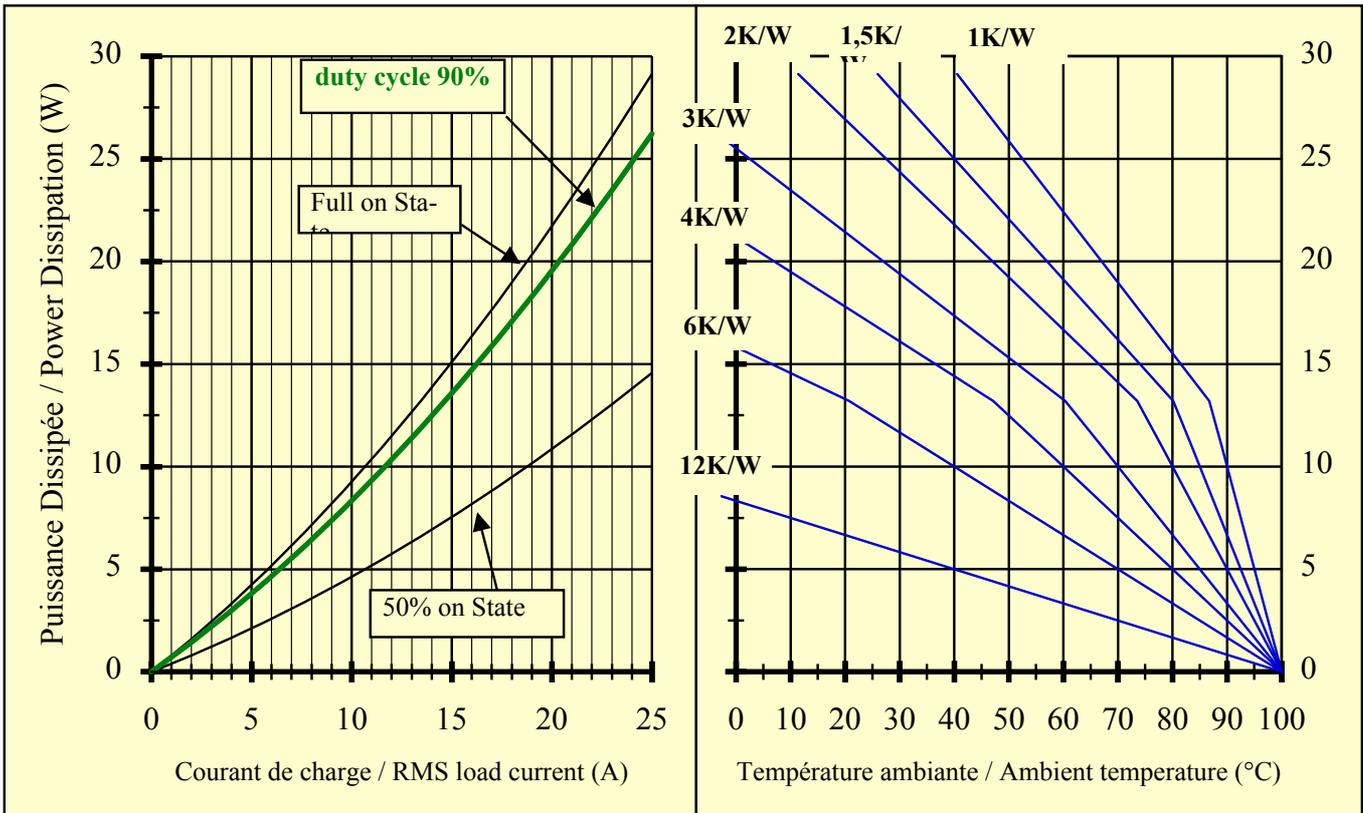
**Courbe de puissance dissipée en fonction du courant commuté et du cycle de marche, de la résistance thermique du dissipateur et de la température ambiante.**
