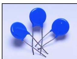
Per proteggere i relè statici da elevati spike di tensione di rete è consigliabile l'uso dei varistori (Mov). I varistori sono componenti a forma di disco con diametro compreso tra 10 e 30mm.
